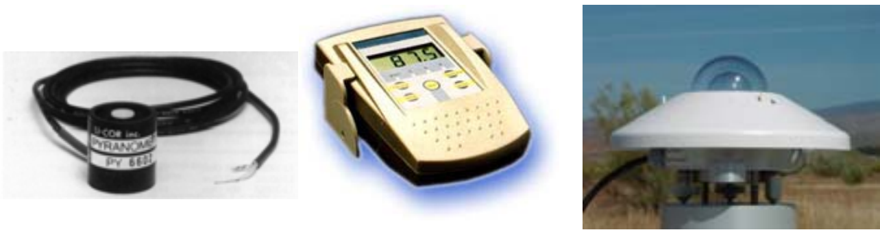
Bild 5: Sensoren bzw. Messgeräte zur Globalstrahlungsmessung: Si-Sensor (links), einfaches Messgerät (mittig) und thermischer Sensor (rechts).
