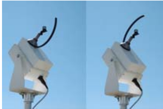
Bild 8: Messgeräte zur Messung der Diffus- und Direktstrahlung. Oben links: Pyranometer mit festem Schattenring; oben rechts: Pyranometer mit nachgeführtem Schattenball; unten links: zweiachsig nachgeführtes Pyrheliometer vor festem Pyranometer; unten rechts: rotierendes Schattenband-Pyranometer in Ruhestellung (links) und während der Rotation (rechts).
