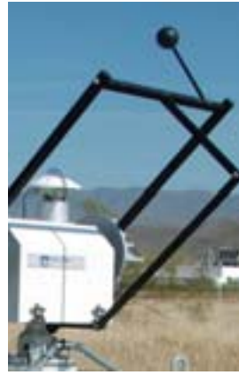
Bild 8: Messgeräte zur Messung der Diffus- und Direktstrahlung. Oben links: Pyranometer mit festem Schattenring; oben rechts: Pyranometer mit nachgeführtem Schattenball; unten links: zweiachsig nachgeführtes Pyrheliometer vor festem Pyranometer; unten rechts: rotierendes Schattenband-Pyranometer in Ruhestellung (links) und während der Rotation (rechts).
