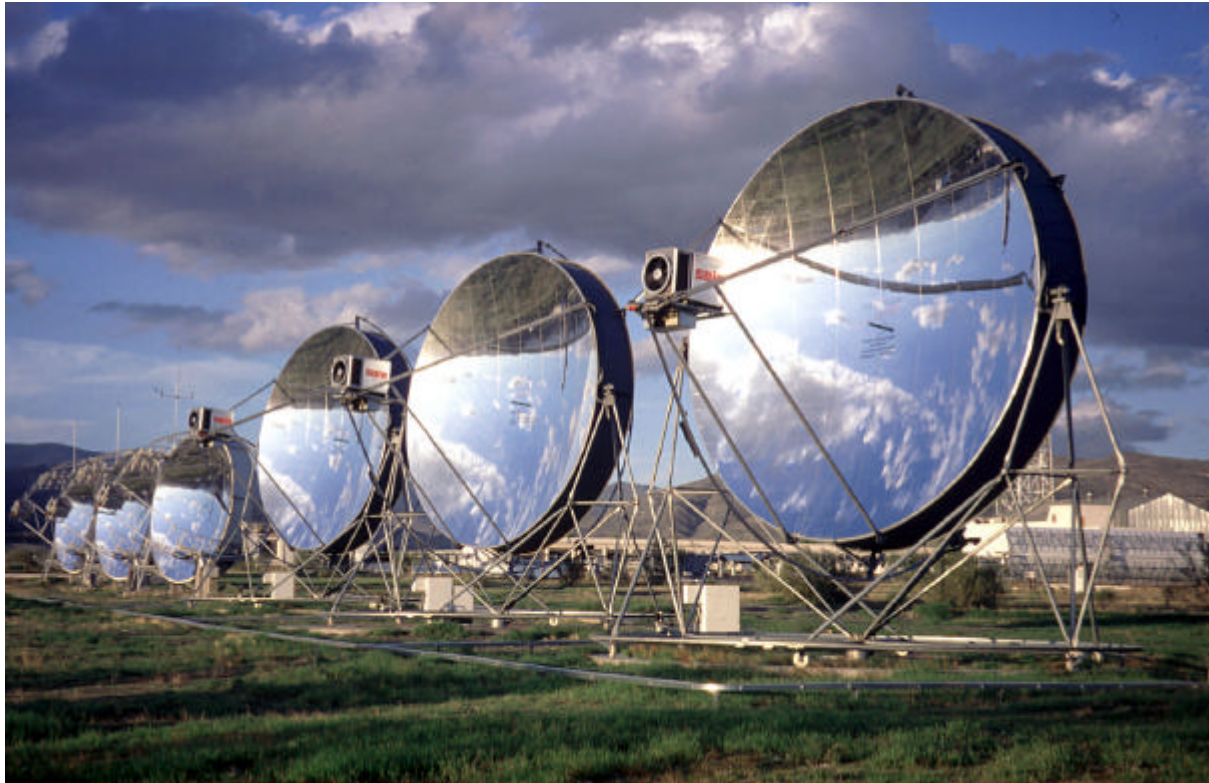
Abb. 5: Dish/Stirling Versuchsanlagen auf dem Testgelände der PSA
